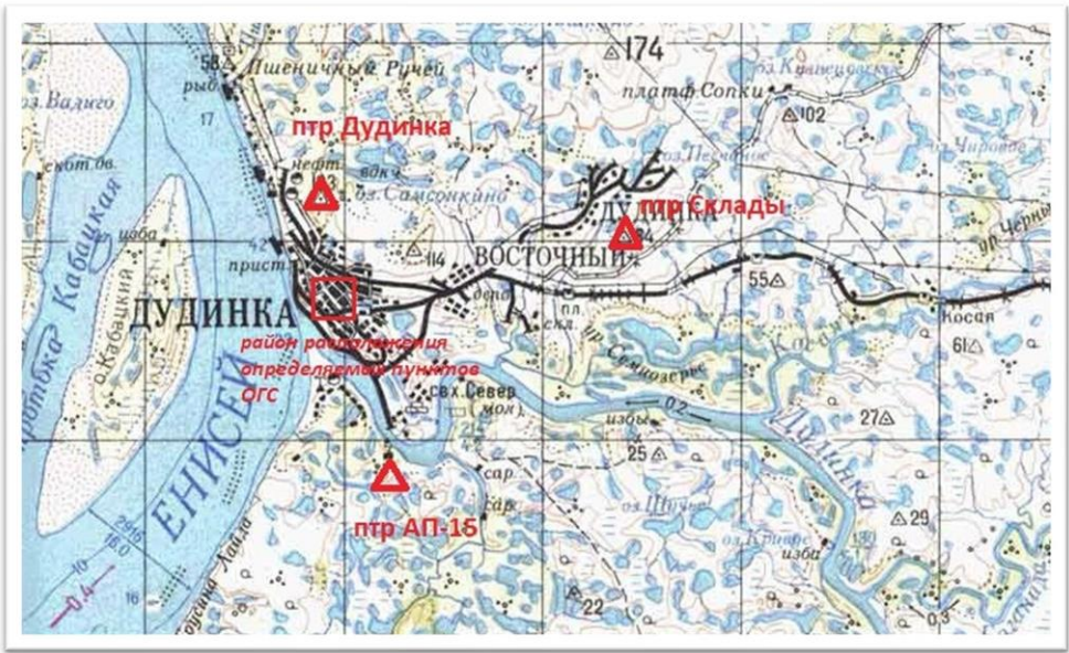
Рисунок 1. Фрагмент карты R-45-21,22, схема расположения исходных пунктов ГГС, которые планируется использовать при определении планово-высотного положения пунктов ПВГС, с использованием линейно-угловых методов (полигонометрия 4 класса, нивелирование IV класса).
